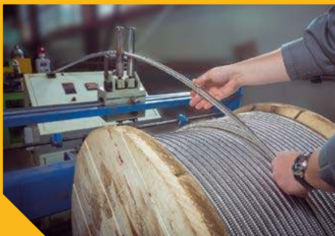
Подача гофрированной трубы Stahlmann для отжига
